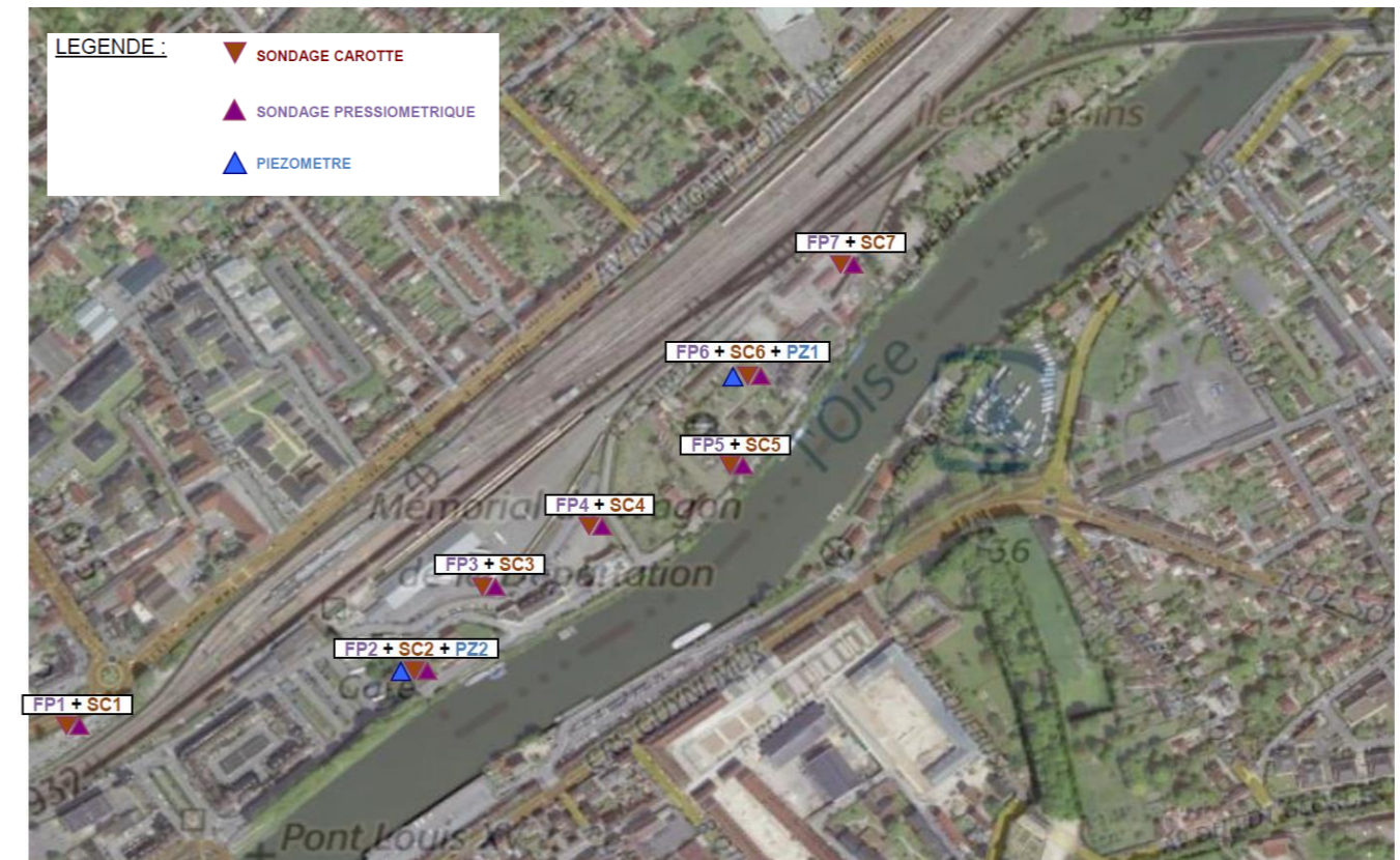
Figure 7 : Schéma d'implantation des sondages réalisés dans le cadre de l'étude géotechnique préalable
